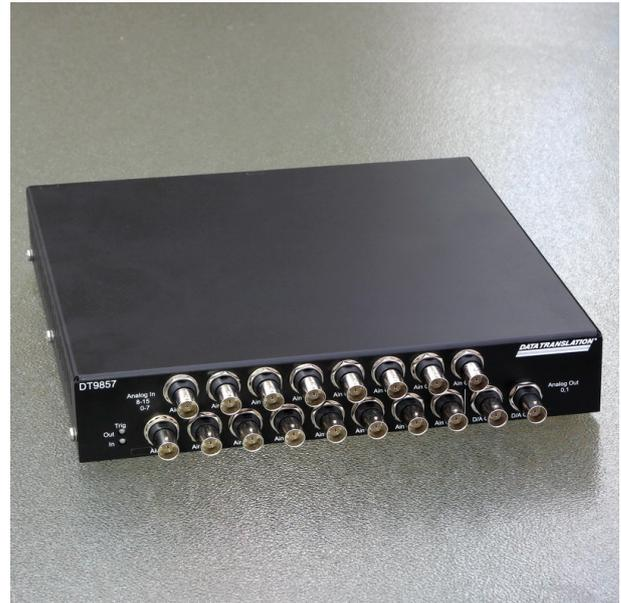
Die Vorverstärkung erfolgt über rauscharme Instrumentenverstärker mit extrem geringer Verzerrung. Für die Stromversorgung von IEPE-kompatiblen Sensoren kann eine Konstantstromquelle softwaregesteuert zugeschaltet werden.
